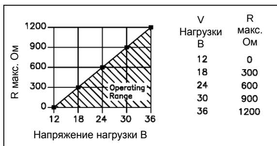
Рис. 3-3 Зависимость сопротивления нагрузки от входного питания
