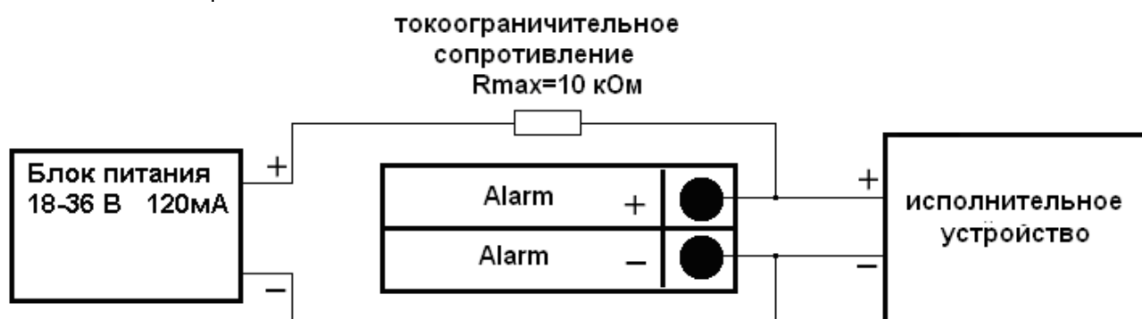
Рис. 3-10. Используйте внешний источник питания, если необходим определенный уровень импульсного сигнала, в частности выше 24 В
